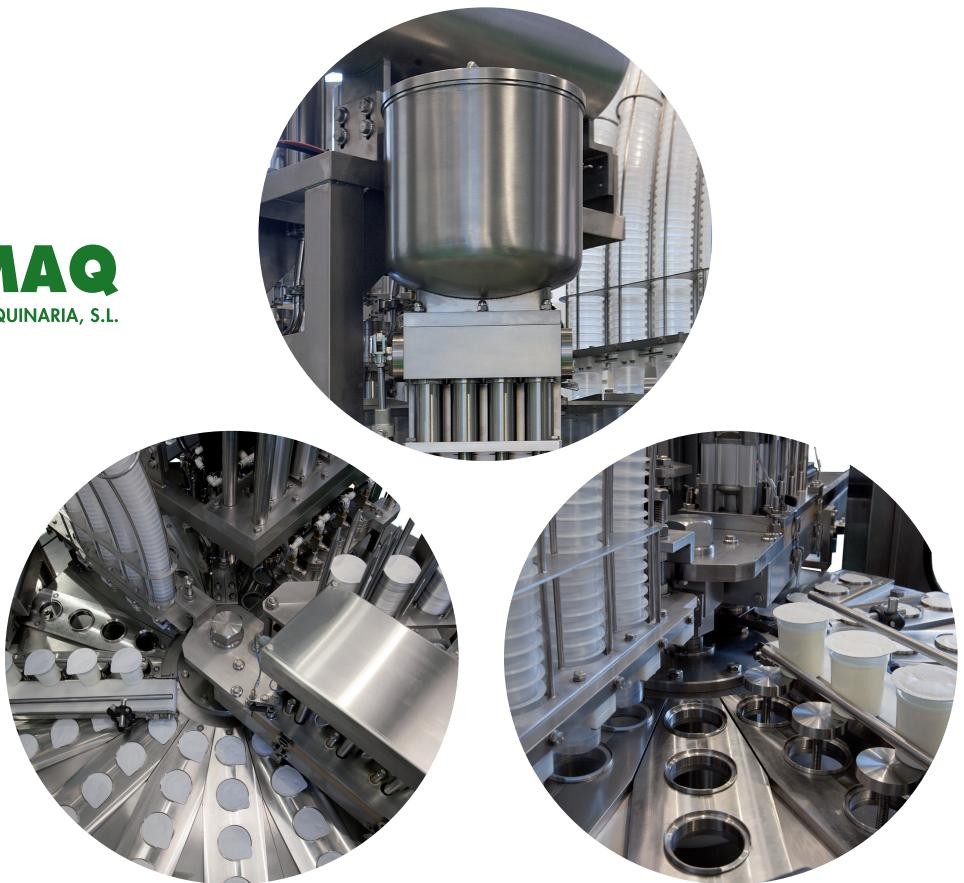
**Máquina automática para el llenado y cerrado de envases rígidos apilables, mediante termosellado, partiendo de tapa precortada o bobina de film continuo.**
